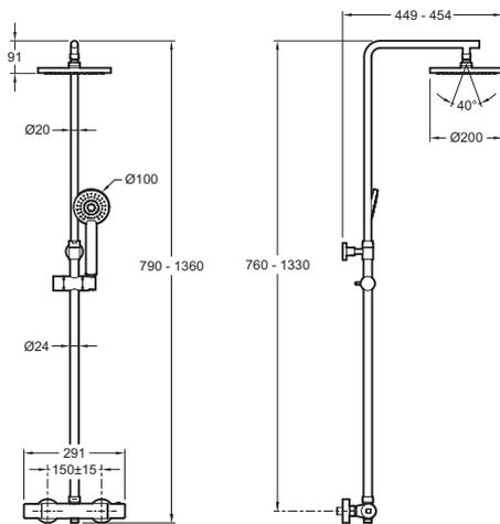
Спецификация продукта : Душевая колонна с термостатом. E25084. Коллекция : MARCEL. МАТЕРИАЛ : N/A. ТИП УСТАНОВКИ : Крепление к стене.
